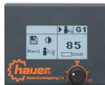
Commande avec écran tactile et potentiomètre
