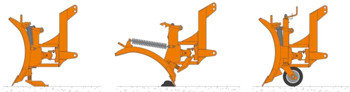
Ko letev s strgalnim robom naleti na oviro (npr. pokrov kanala), se sproži naprava za razklop ob čezmerni obremenitvi, da ima plošča zgoraj prostor. Plošča se spodaj premakne nazaj, da lažje zdrsi čez oviro.
