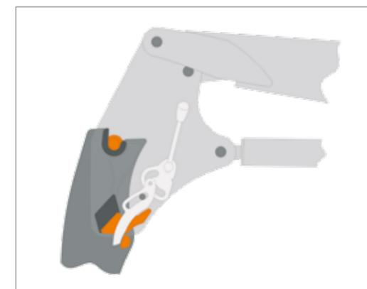
Sur les tracteurs de nouvelle génération, le « système de cadre supérieur » n'est utilisé qu'au cas par cas. Quatre points de fixation sur le cadre du chargeur frontal permettent d'établir la liaison avec la console de fixation sur le véhicule tracteur.
