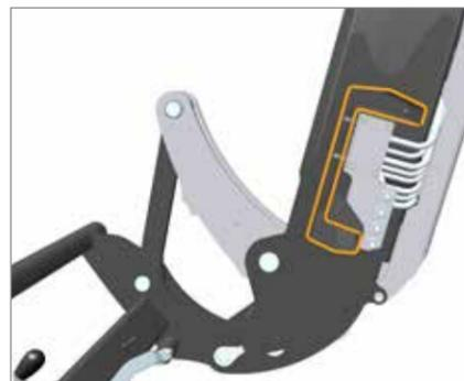
La conception du bras de chargement et de la traverse à double parois a permis de créer une construction indéformable adaptée aux conditions de service les plus difficiles.
