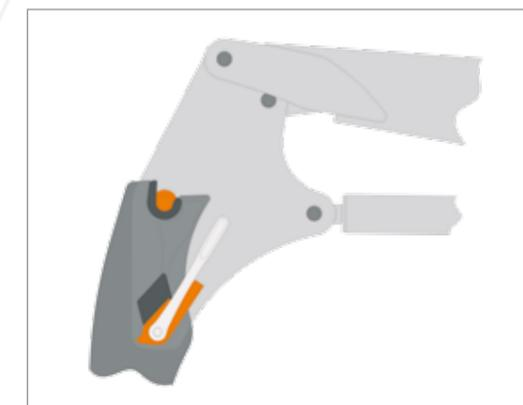
Le système « TOP-BLOCK-KII » est proposé en option du système Top-Block. Ce système d'accouplement se verrouille automatiquement lors de l'accouplement.
