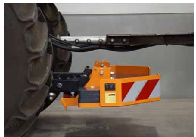
Adhäsionsgewicht im Einsatz mit Anhänger
