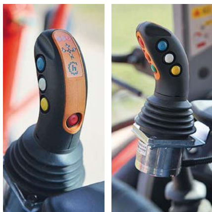
„ELC ergo“ heißt der elektro-proportionale Joystick von Hauer, optional mit automatischer Geräterückführung.
