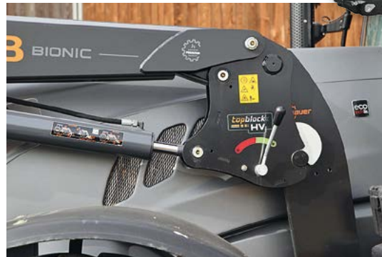
...während bei den großen Modellen die automatische Verriegelung serienmäßig ist.
