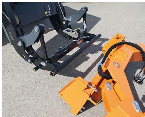
Der Hauer-Anbaurahmen ist stabil, aber auch beim XB Bionic vom Schlepper aus nicht zu sehen...
