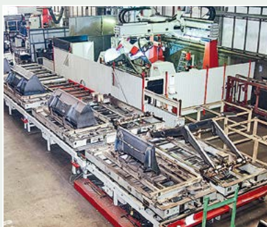
Mit modernsten Maschinen zur Blechbearbeitung sowie Schweißrobotern produziert Hauer jährlich rund 1600 Frontlader. Werkbild
