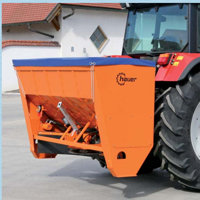
Kompakter Anbau - nahe an der Zugmaschine
