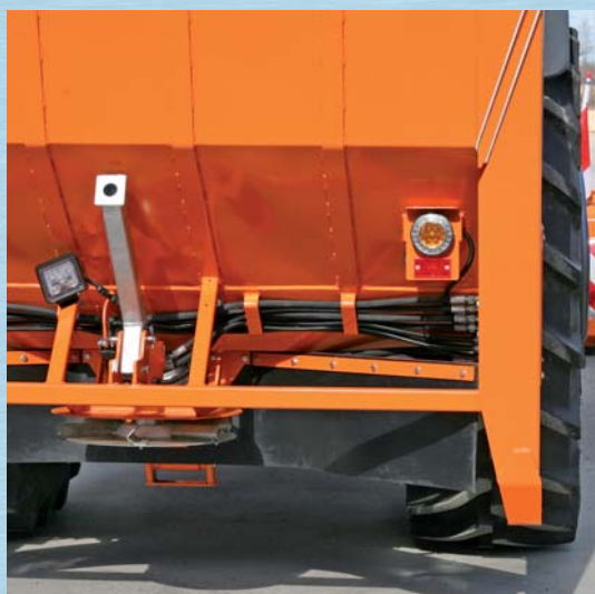
Durchgehende Gummischürze zum Schutz der Zugmaschine
