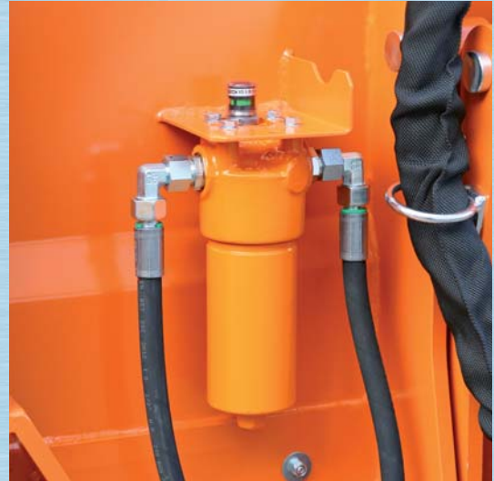
Drucköfilter, für einwandfreie Funktion aller hydraulischen Bauteile
