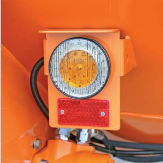
Kombinierte LED-Rückleuchte mit Blinklicht, langlebig und energiesparend
